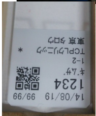
パラフィンブロックの バーコードを読み取ると 日付・ID・属性と バーコードがスライドに 印字される
