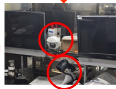
パソコンの電源を入れ、作業する 手元のモニタリングカメラと バーコードリーダーの動作確認
